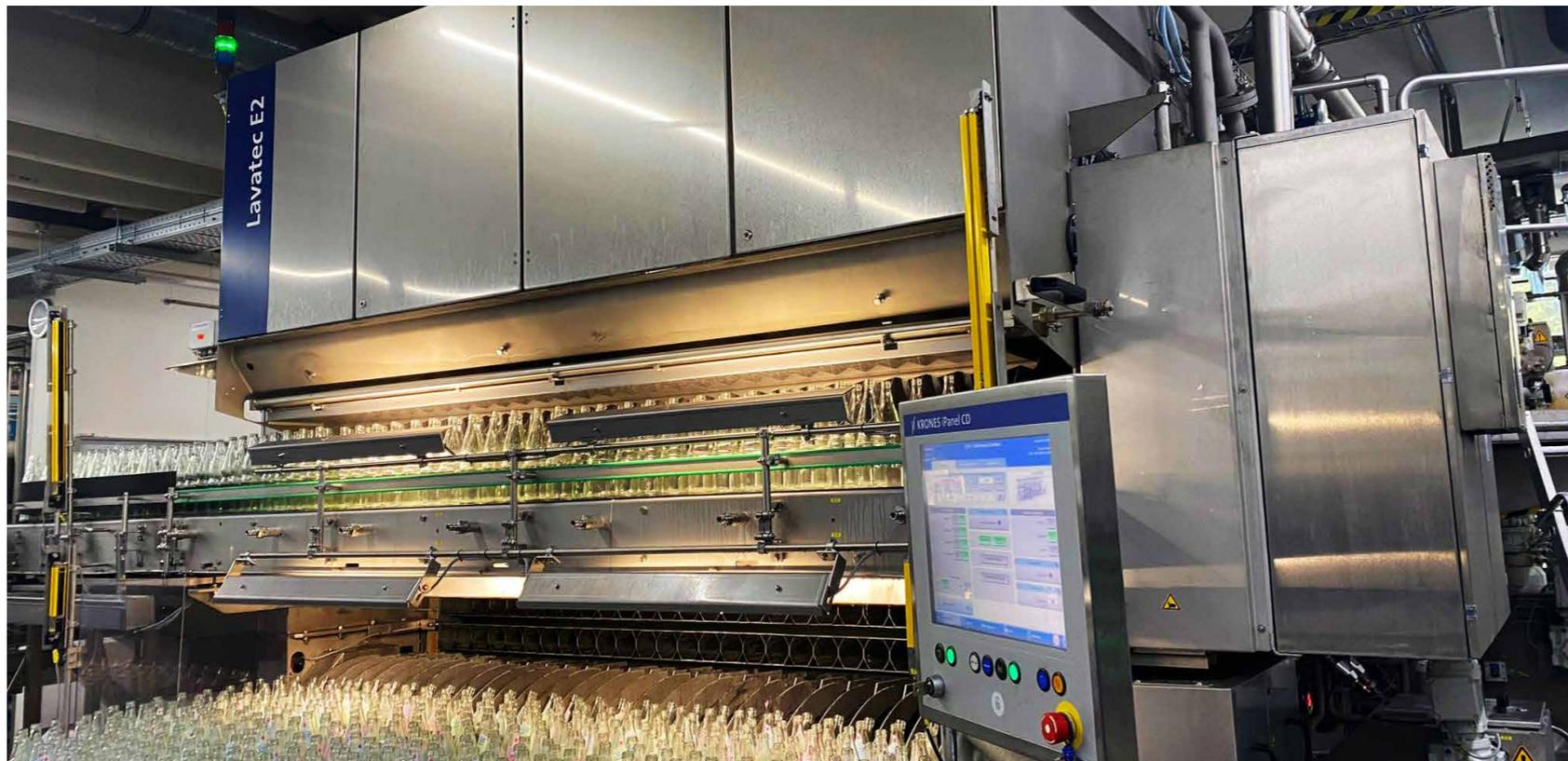
Die vierte Generation investiert in eine hochmoderne Flaschenreinigungsmaschine der KRONES AG. Dieses Anlagegut wurde speziell für die Bedürfnisse des Unternehmens konstruiert und entspricht neuesten energetischen Standards mit einer Leistung von 26.000 Flaschen pro Stunde.
